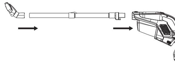
PASO 3: Ajuste el tubo de extensión telescópico a la longitud requerida presionando el botón del tubo de extensión telescópico hacia abajo y deslizando el tubo hacia afuera.
