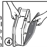
5. Vuelva a colocar la cubierta frontal asegurándose que se encuentra en la posición correcta (la indicada por la flecha) y empuje firmemente en su lugar. Bloquee las dos palancas en sentido horario.
