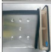
6. Vuelva a instalar el condensador, cuidando de presionarlo de la manera correcta (según indica la flecha) hasta que quede en su posición. Trabe las dos palancas haciéndolas girar hacia la derecha. Asegurarse de que la unidad de condensación está fijada a la base firmemente.
