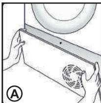
2. Tire firmemente de la empuñadura y saque el recipiente para agua, deslizándolo para retirarlo de la secadora. **(B)**
