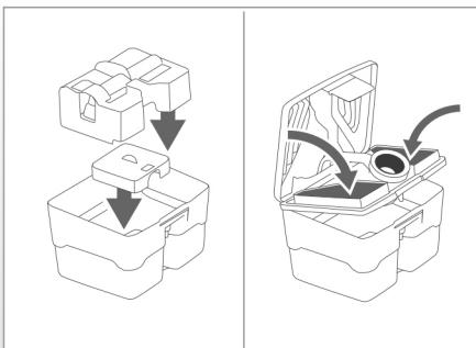
Si le filtre d'aspiration a été retiré, replacez-le dans la cuve d'eau usée.
