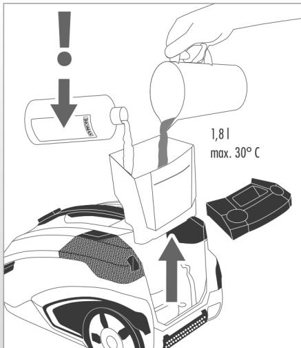
Retirez le réservoir d'eau propre de l'appareil. Remplissez le réservoir d'eau propre vide avec 1,8 litre d'eau propre au maximum (tiède, maximum 30 °C). Replacez le réservoir d'eau propre dans l'appareil. Pour le montage et le démontage du réservoir d'eau propre, voir le chapitre « Nettoyage », section « Nettoyer le réservoir d'eau propre ».
