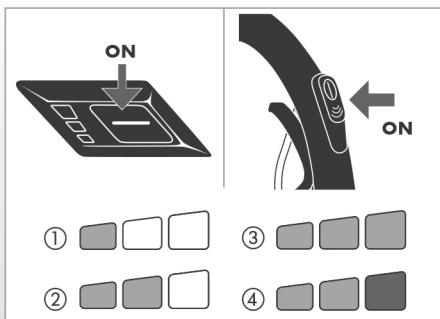
Allumez l'appareil en appuyant brièvement sur la touche de démarrage de l'appareil même ou de la télécommande\*. L'appareil démarre en mode Éco, ce qui est indiqué par le fait que deux bandes d'affichage vertes s'allument.
