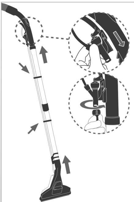
**Raccordez le tube télescopique à la poignée du flexible d'aspiration et au suceur d'aspiration-lavage pour sols.**
