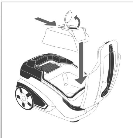
Aspiration de matières sèches avec système de sacs\***Montez le système de sacs.**
