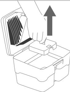
Si de la saleté se trouve encore dans la cuve d'eau usée de l'Aquafilter, nettoyez celui-ci soigneusement en le passant sous l'eau et déversez l'eau usée par l'orifice d'évacuation.
