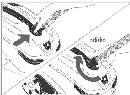
**Raccordez le flexible d'aspiration à l'appareil.**
