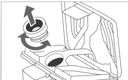
En cas de fort encrassement, il est possible de retirer l'injecteur en tournant le joint du raccord, afin de le nettoyer.
