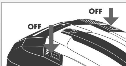
Lorsque le réservoir d'eau propre est vide ou à la fin du nettoyage, éteignez la pompe en appuyant sur la touche de la pompe. Éteignez l'appareil en appuyant sur la touche de démarrage.
