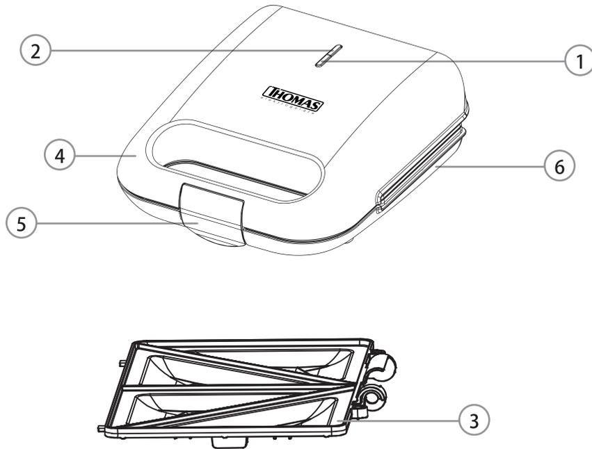
1.- Luz roja - indicadora de encendido y precalentado
